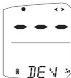
速度を4ノット以下に保ちながら、約2分かけてゆっくりと360度回転させる。ディスプレイの表示が変わるまで（通常約1.25回転）、本船を回転させ続ける。
