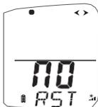
すべてのキャリブレーション設定を工場出荷時の値に戻します。●を押すと、3秒間のカウントダウンが始まり、終了するとすべての設定値が初期値に戻ります。再度●を押すと、カウントダウンを停止し、リセットを解除することができます。
