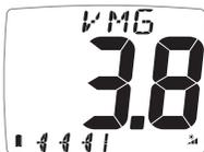
できるだけ速やかに風上のマークに到達するには、指向角とボートの速度とのバランスをとって、風に直接向ける速度を最大にする必要があります（この速度は風速に適した風速です）。
