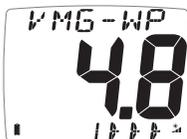
真風の角度と一緒にVMG-WP (VMGからウェイポイント) を使用してVMGを風下のマークに最適化します。
