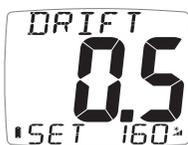
ボートが常にコンパスの方向に直接移動するわけではないので、ボートがコースから押し出される方向 (SET) と速度 (DRIFT) を知る必要があります。 戦術的には、マークを丸めるか、障害物や岬を取り除くかを判断するときに重要です。
