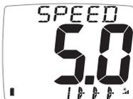
速度ページは、あなたの加速または速度傾向を示すように構成することができます。これを使用してセイルトリムの変更を評価します。
