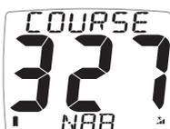
ターンページと同様の状況で使用される「コース」ページには、ウェイポイントに直接向かうように操縦するコースが表示されます。
