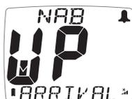
ウェイポイント到達信号がGPSから受信された。ウェイポイント名はディスプレイの最上部に表示されます。
