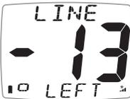
Line Biasページに進み、スタートラインに沿って直接航行し、
