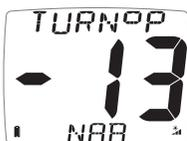
潮汐条件でウェイポイントに向かって操舵する場合、コースへのダイレクトコースを維持するように操縦するためのコースを評価することはしばしば困難です。マキシディスプレイは、あなたがステアリングしているコースが、あなたのウェイポイントへのダイレクト・トラックを離れていることを自動的に示します。
