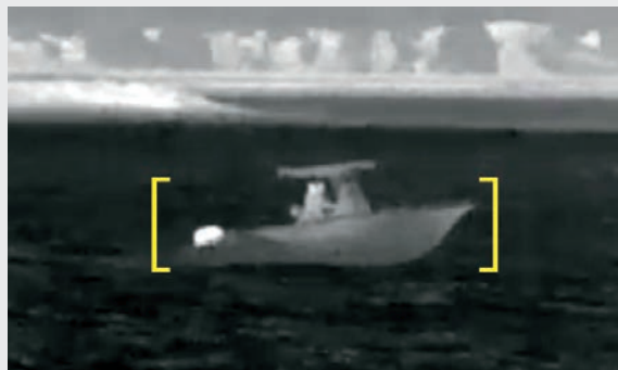
ClearCruise™は、Axiomディスプレイに接続されたときに物体を黄色い枠で囲い、アラームを鳴らします。
